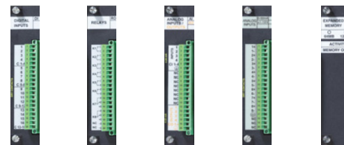
Дискретные входы Релейные выходы Аналоговые входы/выходы Высокоскор. аналоговые входы Расширенная память
